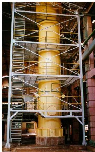
Coluna industrial para concentração mineral por flotação
