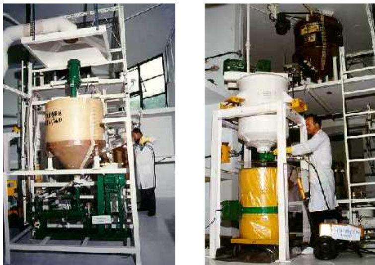
Figura 3 – Sistemas de precipitação química e cimentação de rejeitos de baixo nível de radiação
