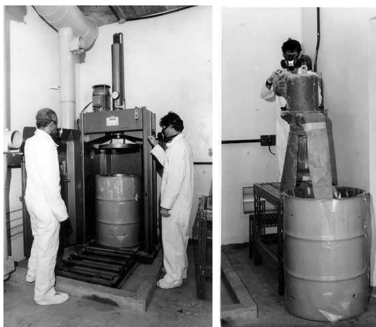
Figura 6 – Sistemas de compactação e corte de rejeitos sólidos
