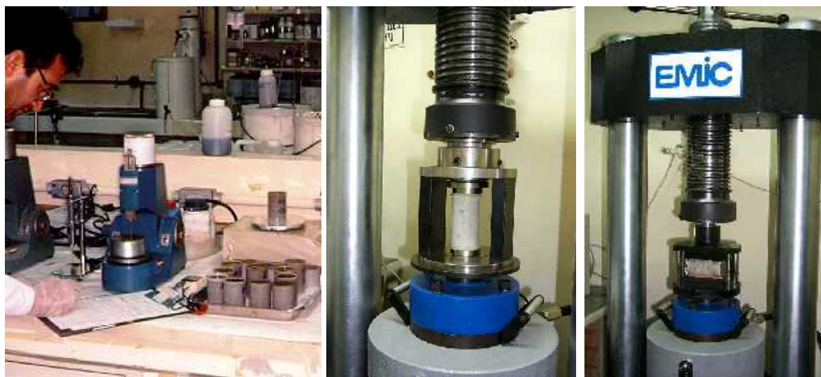
Figura 5 – Ensaio para a avaliação do processo e do produto de cimentação (Tempo de pega, resistência à compressão e resistência à tração)
