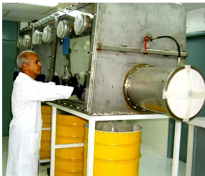
Figura 8 – Caixa de luvas para desmonte dos pára-raios e detetores de fumaça
