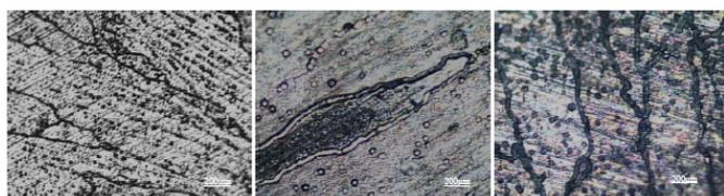
Figura 2 – Micrografias das três amostras após ensaio DL na solução 0,05 M de H<sub>2</sub>SO<sub>4</sub> + 0,0001 M CH<sub>3</sub>CSNH<sub>2</sub>.
