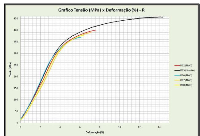
Figura 2: Curva tensão versus deformação, sentido R.
