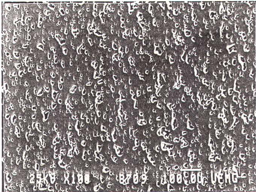
Figura 2 - Micrografia eletrônica mostrando a estrutura de poros.
