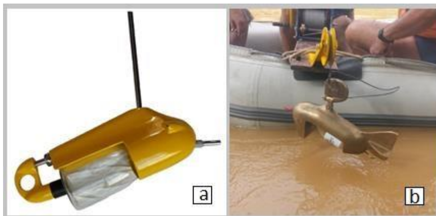
Figura 6. Amostradores de sedimento em suspensão. (a) Amostrador DH-48 (medição à vácu); (b) amostrador DH-59 (medição a partir de embarcação com guincho). Fonte: Projeto Sustentabilidade da Bacia do Rio Pandeiros (Linha Temática: Dinâmica de Vertentes da Bacia do Rio Pandeiros).
