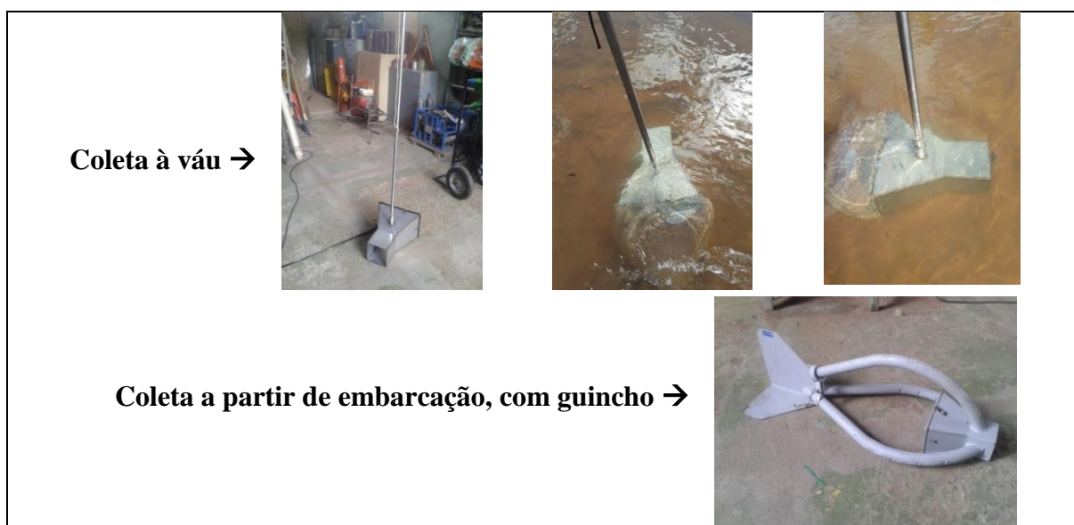
Figura 8. Coleta de sedimento de arraste - Amostradores Helley Smith.
