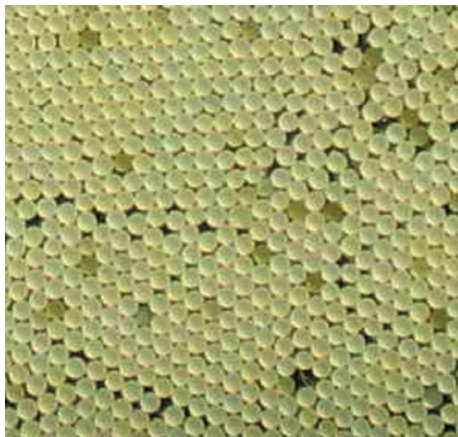
Figura 2 - Microesferas secas de ThO_2 .
