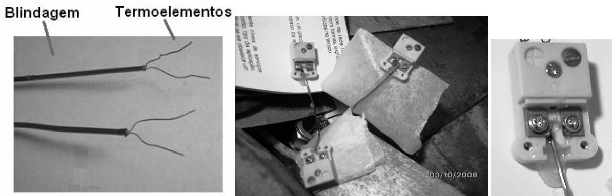
Fig. 8. Dois termopares após a remoção da blindagem e do isolamento, e termopares fixados aos conectores.
