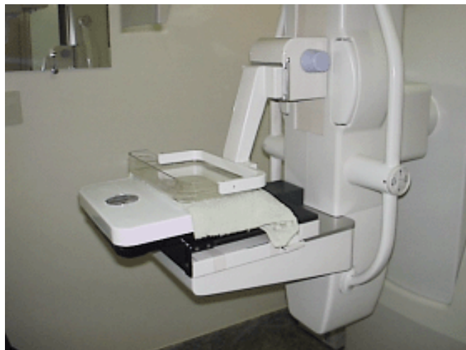
FIGURA 12 – Posicionamento da balança para medida de força de compressão.
