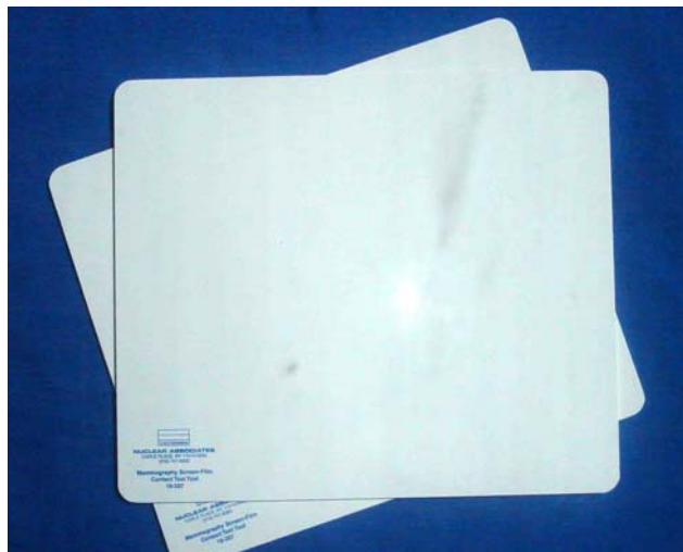
FIGURA 14 – Objeto de teste (malha metálica) usado para teste de integridade dos chassis.
