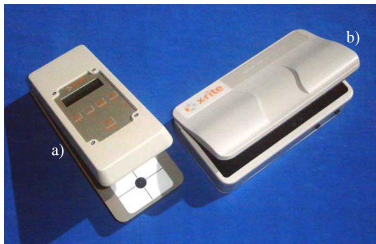
FIGURA 15 – Sensitômetro (a) e densitômetro (b) usados na avaliação do sistema de processamento.
