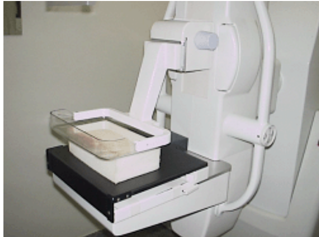
FIGURA 13 – Teste de alinhamento da bandeja de compressão.
