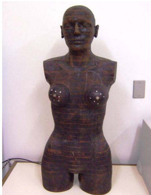
Figura 9 - Simulador antropomórfico para medida de dose absorvida
