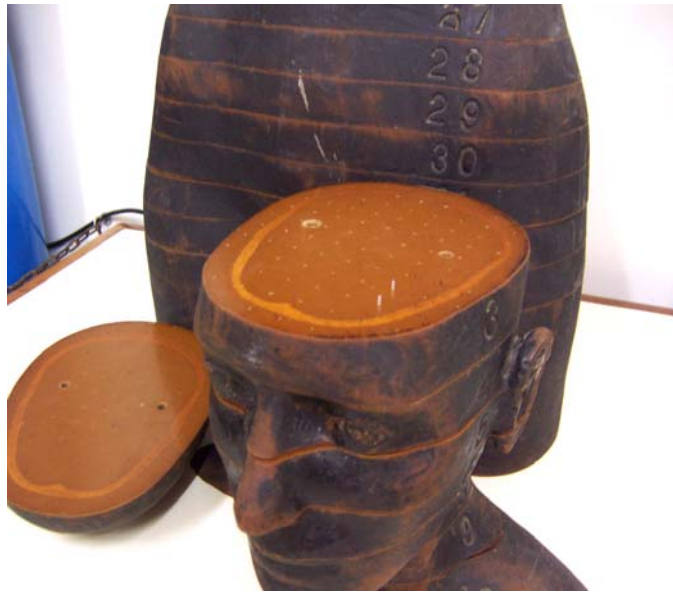
Figura 10 - Simulador antropomórfico seccionado com dosímetros termoluminescente
