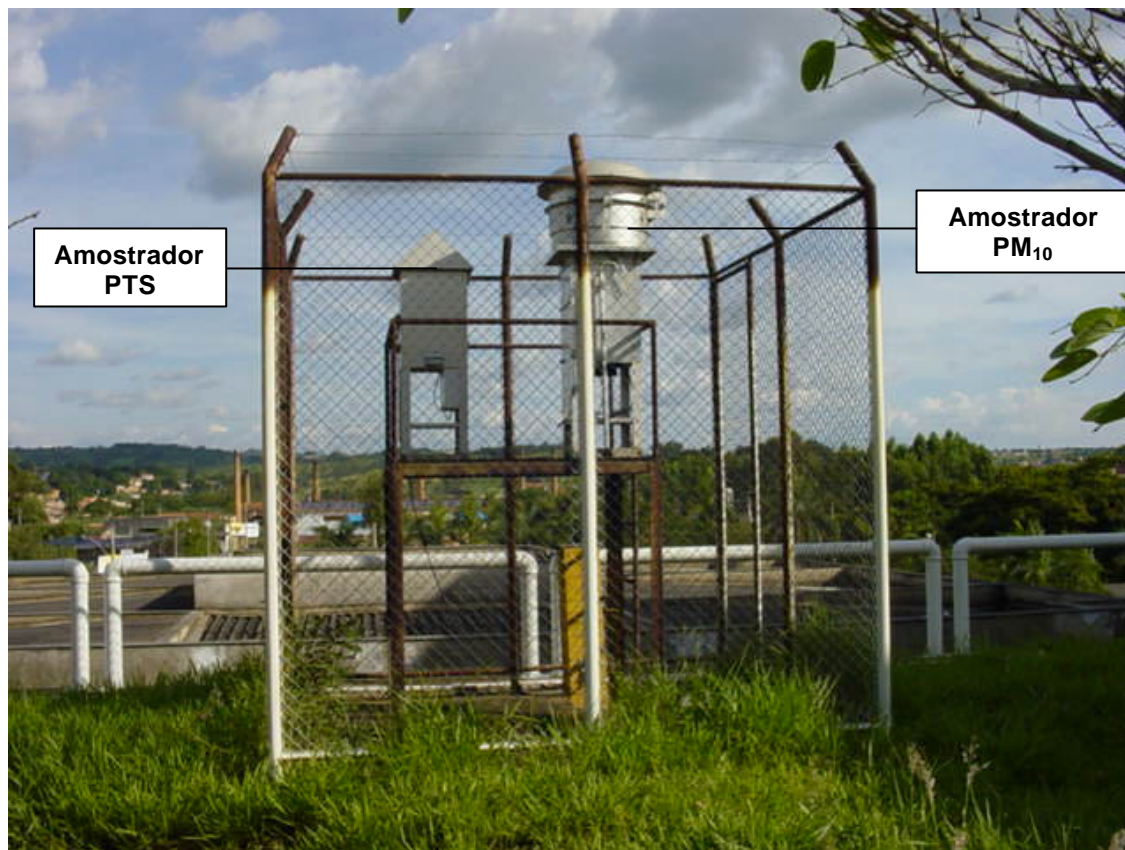
FIGURA 6.1. Estação de Amostragem da Qualidade do Ar.
