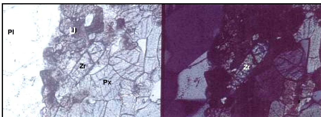
Figura 6.4: Uraninita presente no piroxênio da lâmina (03JUN26-56). Presença de zircão (fonte provável de urânio) incluso no piroxênio. Pl: plagioclásio, Px: piroxênio, U: uraninita e Zr: zircão. Aumento: 200X – Sob nicóis: paralelos e cruzados (direita).
