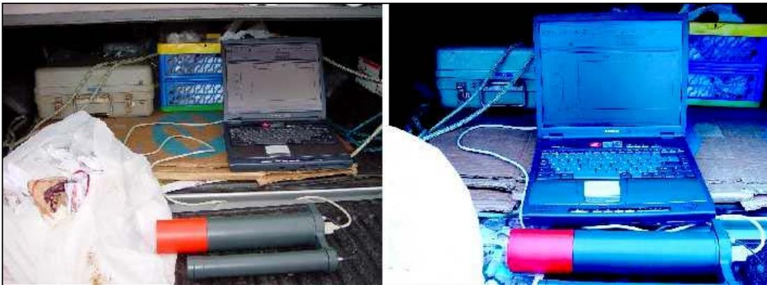
FIGURA 36 – Utilização do nanoSPEC na identificação de um espectro de  $^{99m}\text{Tc}$ .
