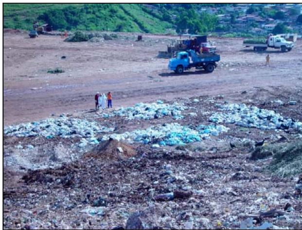
FIGURA 34 – RSS quarteado pronto para a medição.
