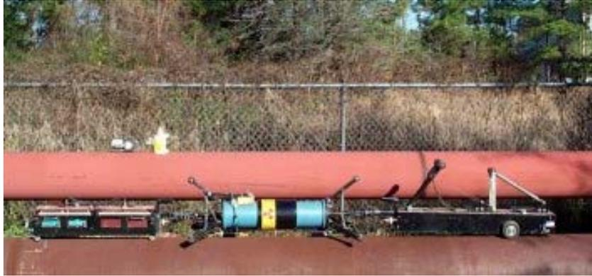
FIGURA 1 – Gamagrafia industrial de uma tubulação (HI-TECH TESTING, 2004).
