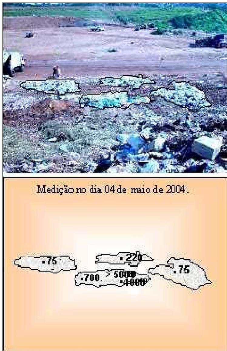
FIGURA 45 – Croqui mostrando o resultado do quarteamento e as contagens obtidas em cada segmento avaliado.
