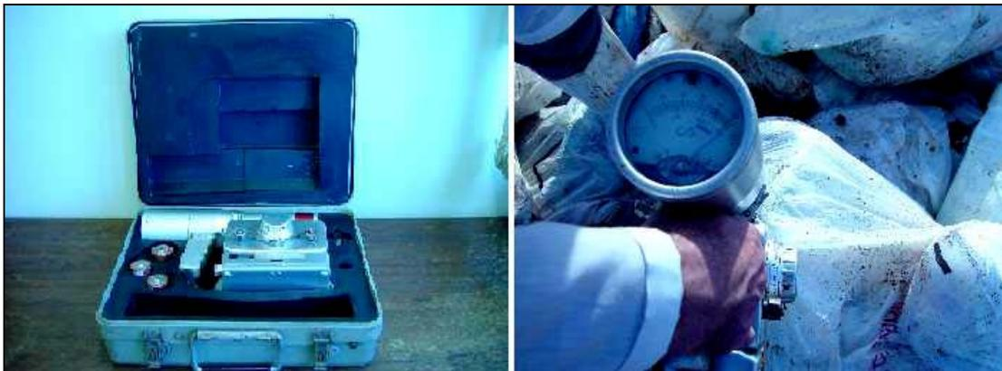
FIGURA 30 – Cintilômetro SPP-2 na embalagem e em operação.
