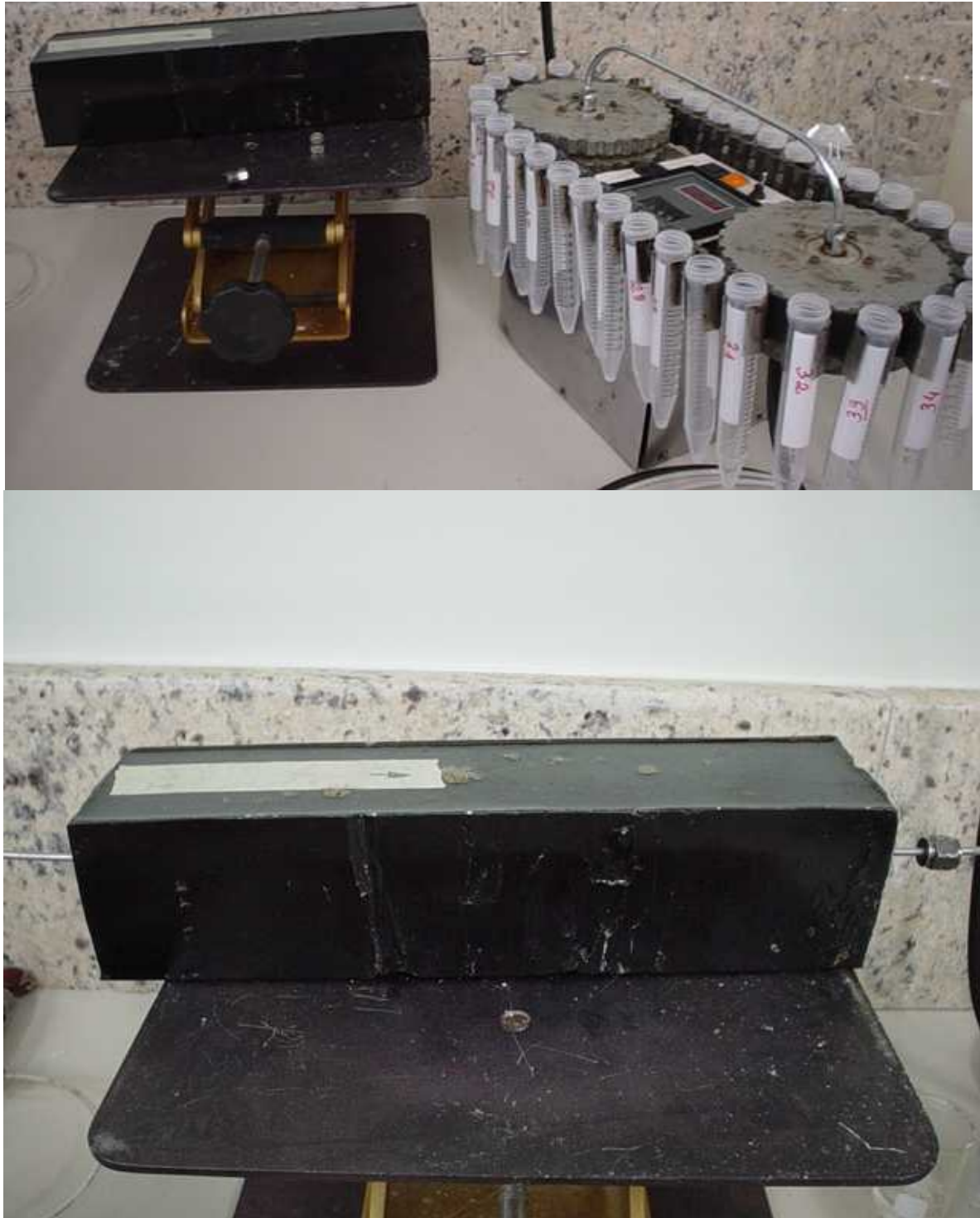
FIGURA 9: Corpo de prova encapsulado e sistema coletor de amostras
