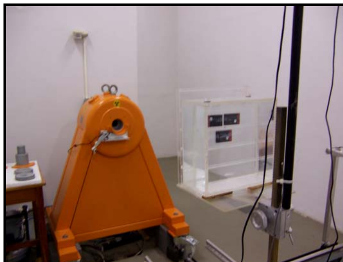
FIGURA 17 – Arranjo da calibração do dosímetro em termos de Hp(d).
