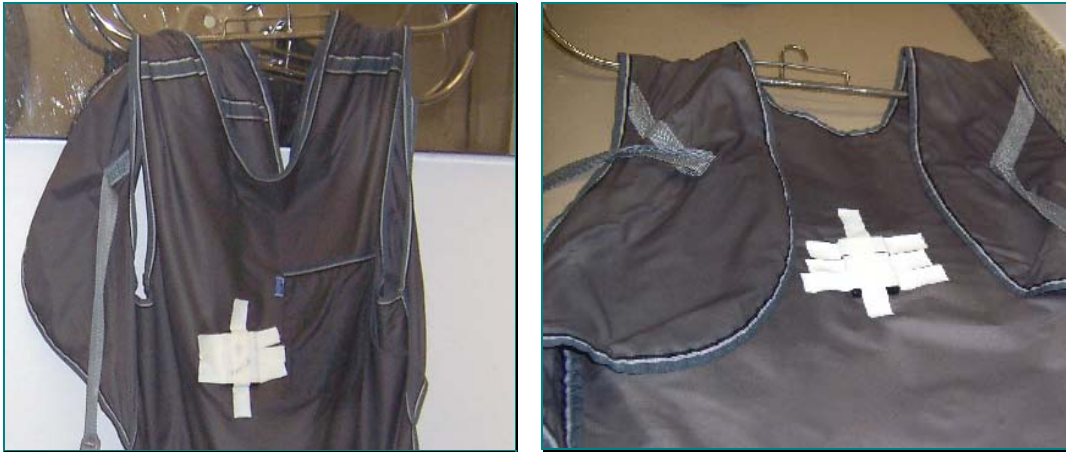
FIGURA 23- Fixação dos dosímetros nos aventais protetores.
