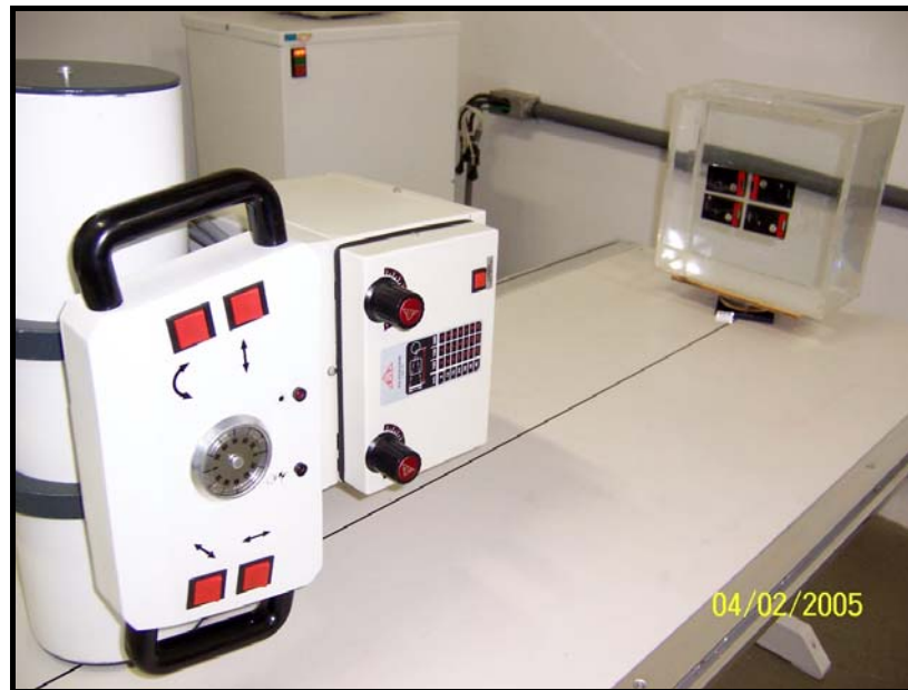
FIGURA 18 – Arranjo para a verificação da dependência energética do dosímetro.
