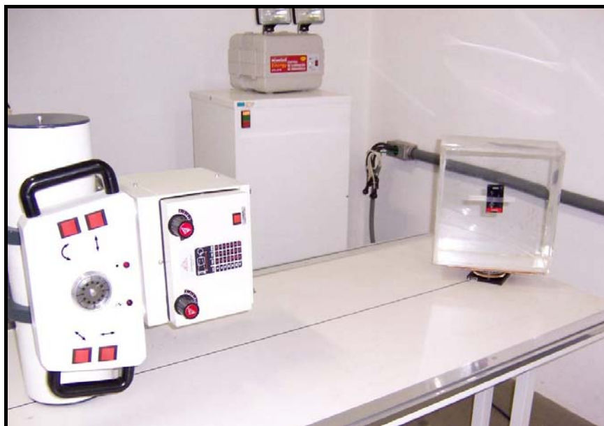
FIGURA 20 – Arranjo para a verificação da dependência angular do dosímetro.
