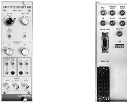
Figura A2-7 – Painel Frontal e Traseiro do Módulo Amplificador
