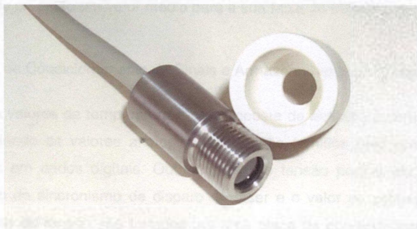
Figura 4.7 - Sensor infravermelho e capa usada para promover o alinhamento entre o sensor e a amostra e proteção contra o feixe de energia emitido pelo laser.
