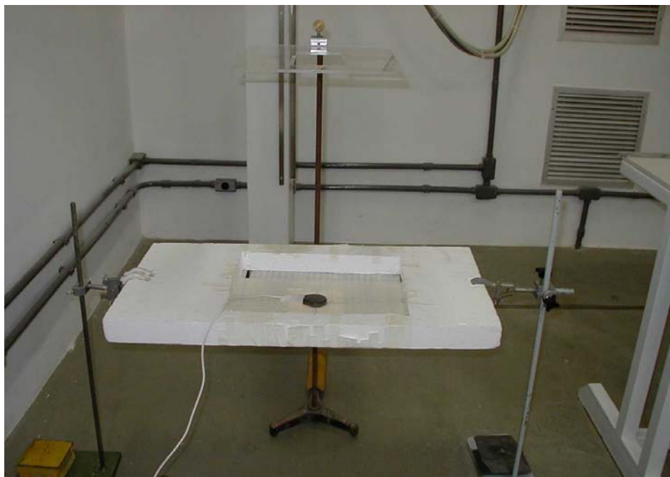
FIGURA 46 - Detalhe arranjo experimental com a câmara 10X5-60 acoplada ao eletrômetro modelo 9010.
