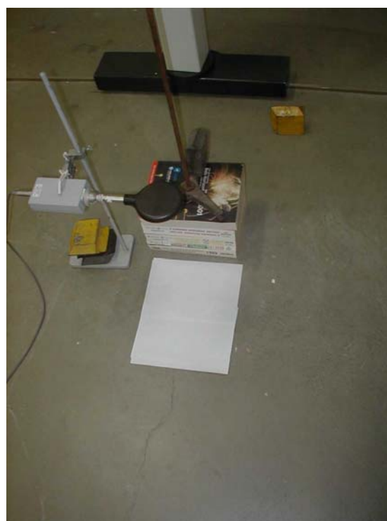
FIGURA 47 - Detalhes do arranjo experimental com a câmara 10X5-180 acoplada ao eletrômetro modelo 9010.
