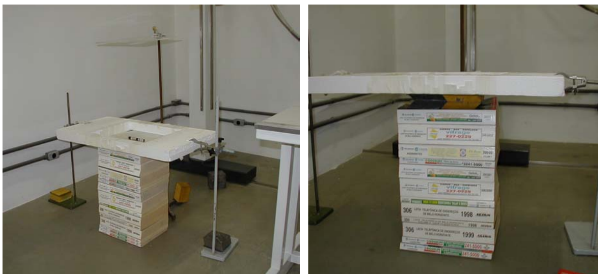
FIGURA 49 - Vista geral do arranjo experimental para caneta dosimétrica posicionada sobre camadas de papel e blocos de chumbo.
