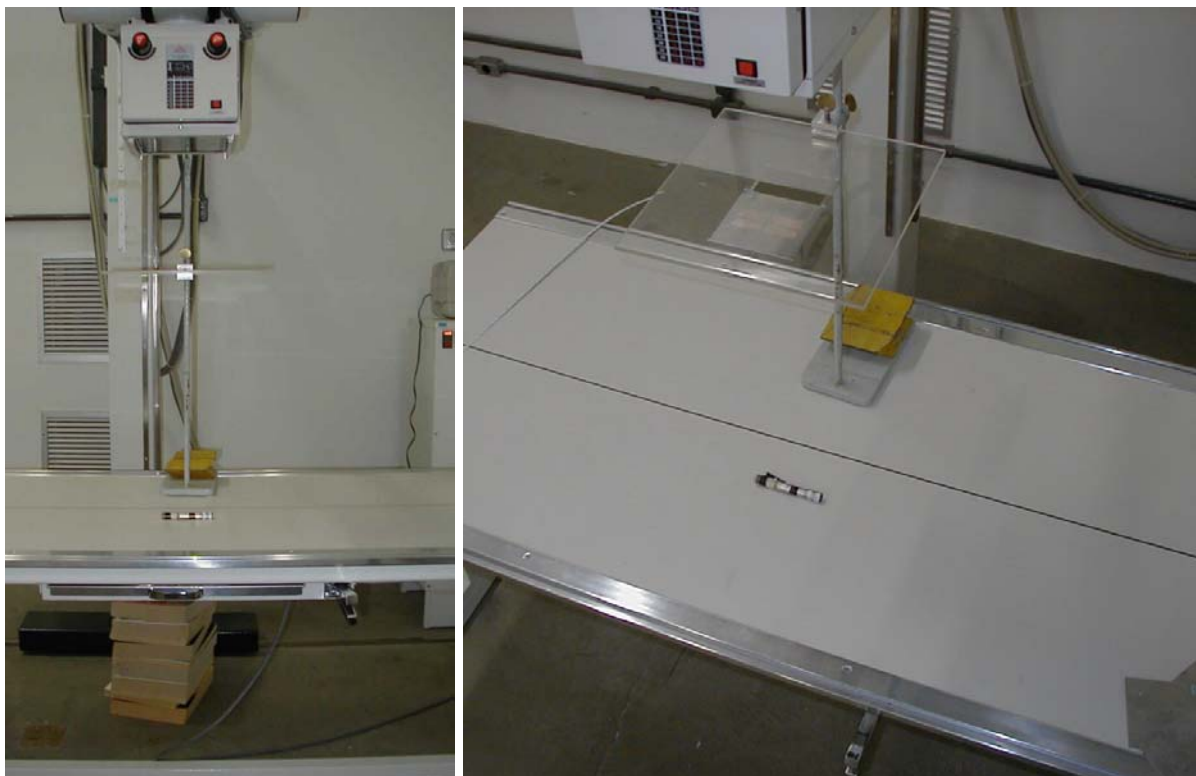
FIGURA 50 - Vista geral do arranjo experimental para caneta dosimétrica posicionada sobre a mesa de exames.
