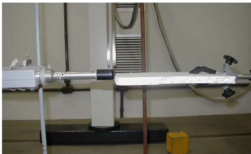
FIGURA 42 - Detalhe do posicionamento coincidente do ponto de referência da câmara ao ponto de referência dos TLD's.
