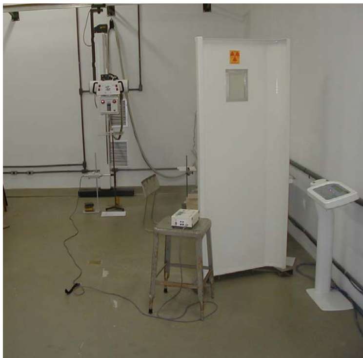
FIGURA 44 - Vista geral do arranjo experimental para determinação do valor ótimo da CSR.
