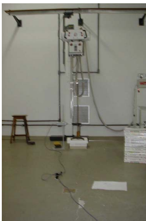
FIGURA 47 - Detalhes do arranjo experimental com a câmara 10X5-180 acoplada ao eletrômetro modelo 9010.
