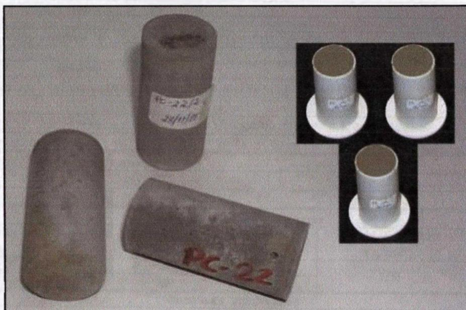
**FIGURA 5: Corpos-de-prova confeccionados fora e dentro dos moldes**
