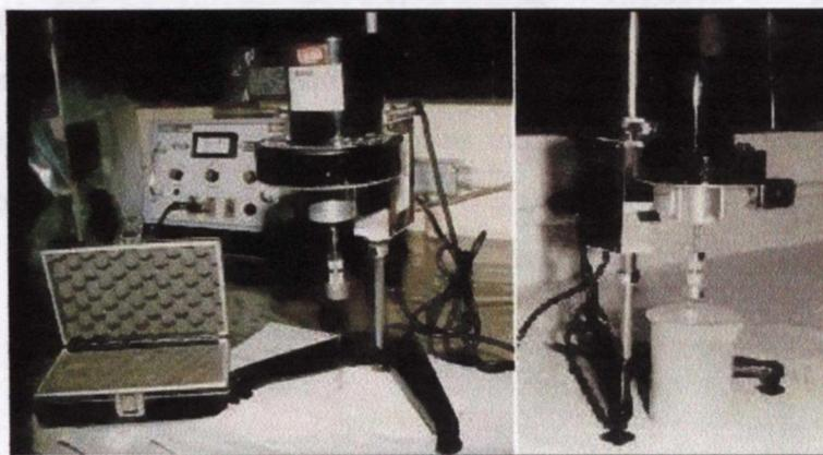
**FIGURA 8: Viscosímetro utilizado para a determinação da viscosidade da pasta**
