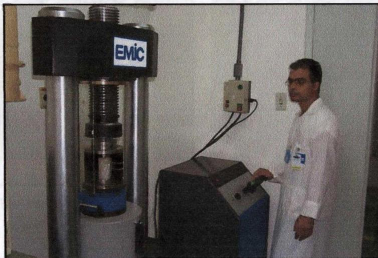
**FIGURA 9: Prensa utilizada para os ensaios de resistência à compressão**
