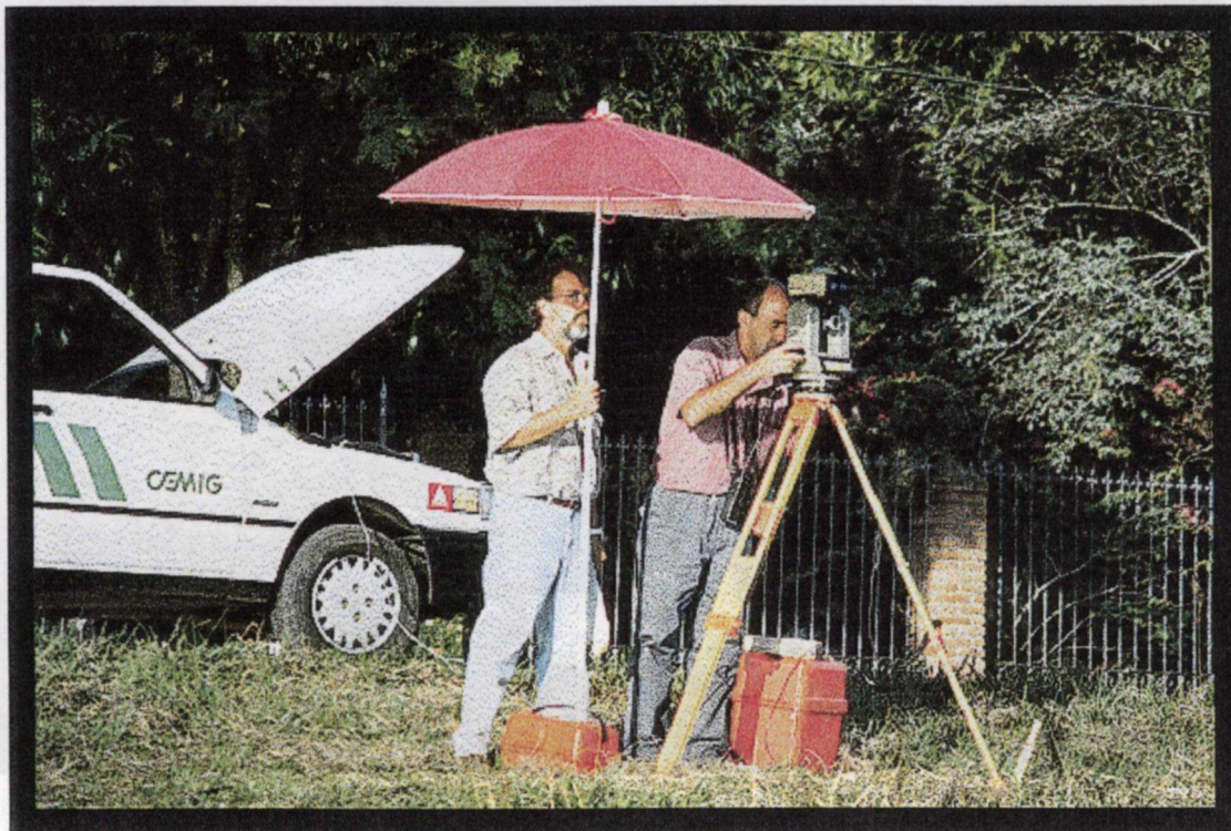
Foto 4.8 – Estação de posicionamento total marca WILD, composta por um teodolito T2000 e um coletor de dados marca GRE3
