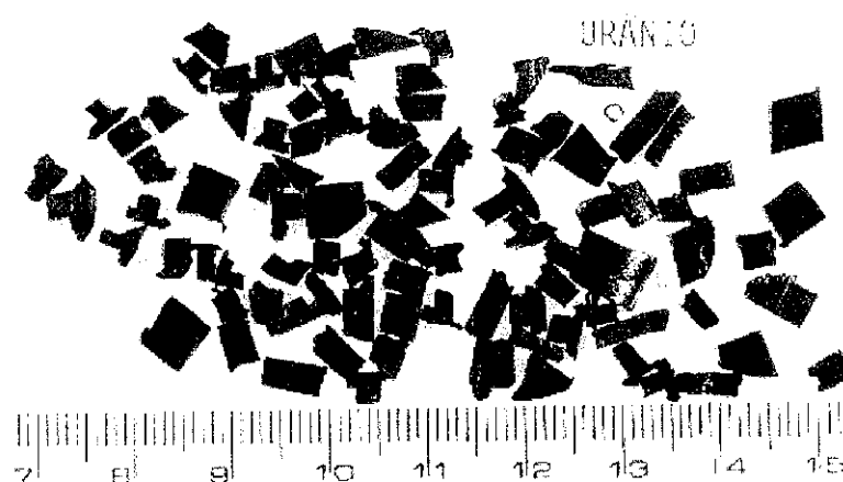
FIGURA 4.14 - O urânio, após ser seccionado em pequenos pedaços, para ser compactado com a esponja de zircônio.
