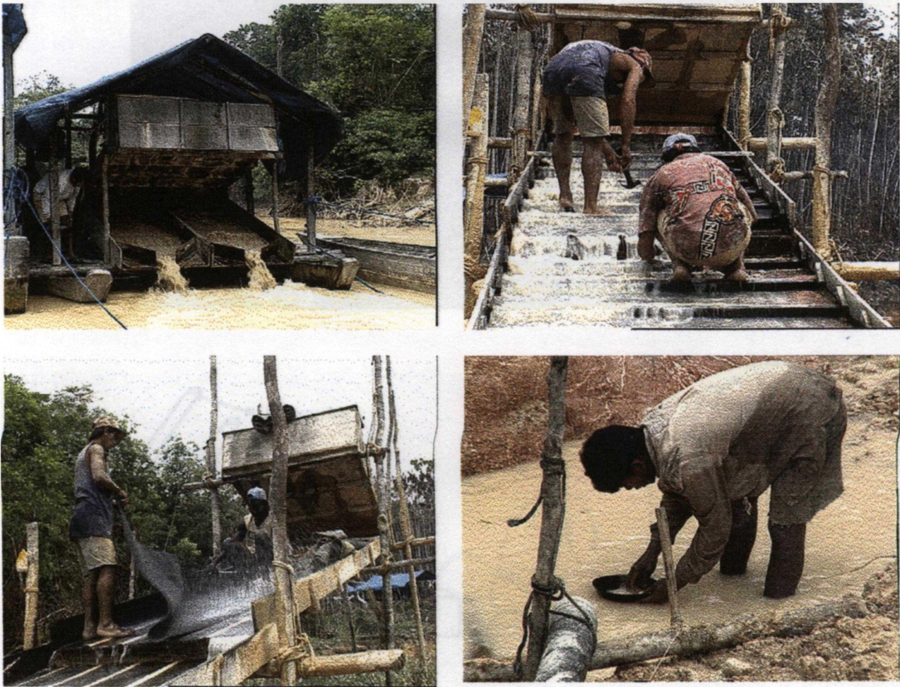
Figura 1.8 – Etapas do processo de concentração de ouro
