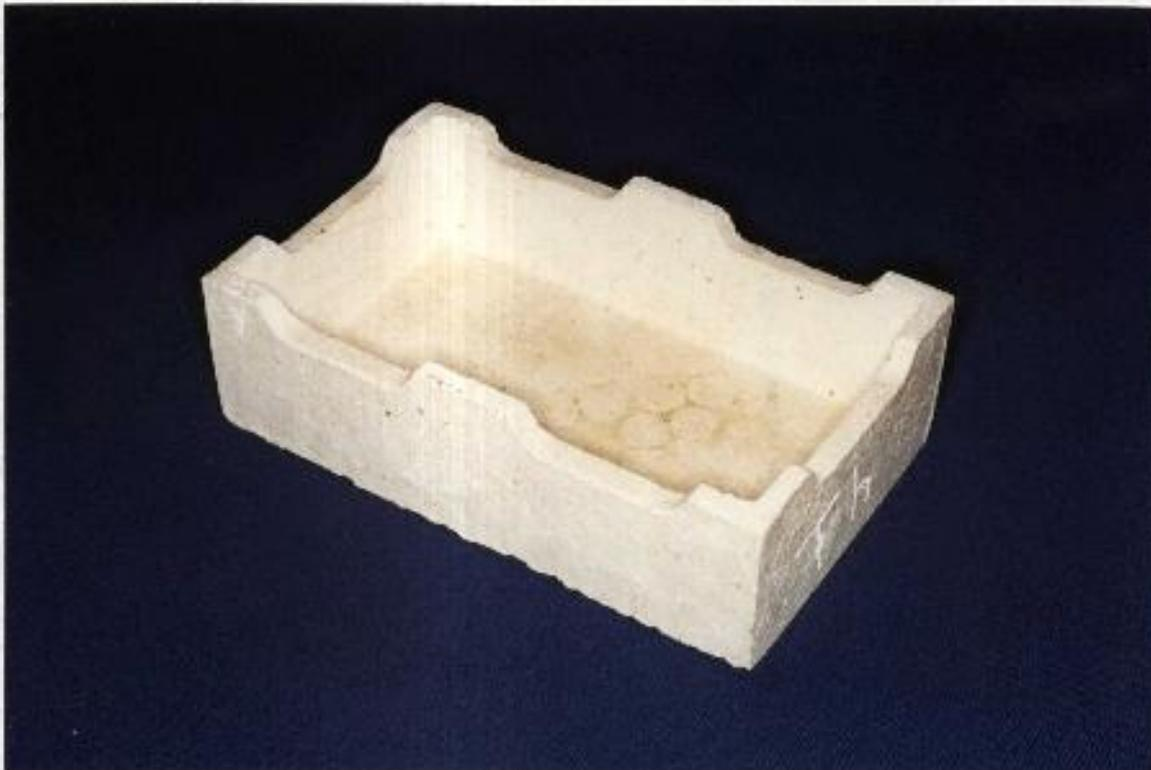
**Figura 10 - Bandeja refratária utilizada na calcinação das microesferas.**
