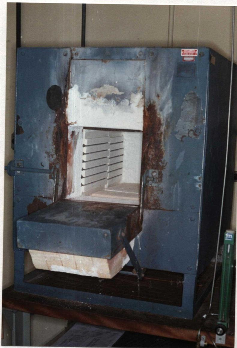
**Figura 11 - Forno tipo mufla utilizado na calcinação das microesferas.**
