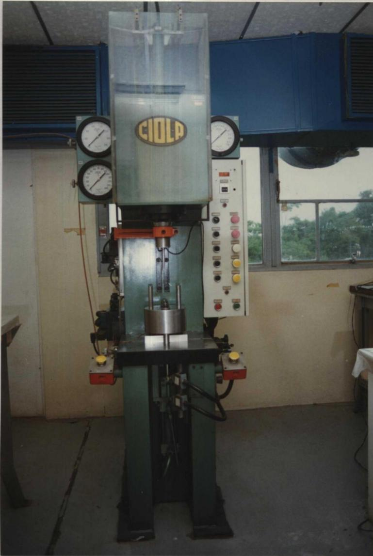
Figura 13 - Prensa hidráulica automática utilizada na prensagem das microesferas.
