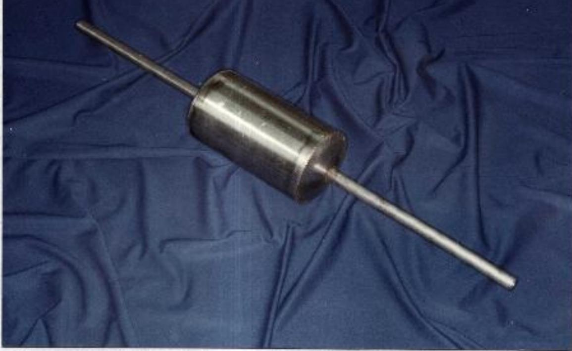
**Figura 12 - Câmara rotativa utilizada na redução das microesferas.**
