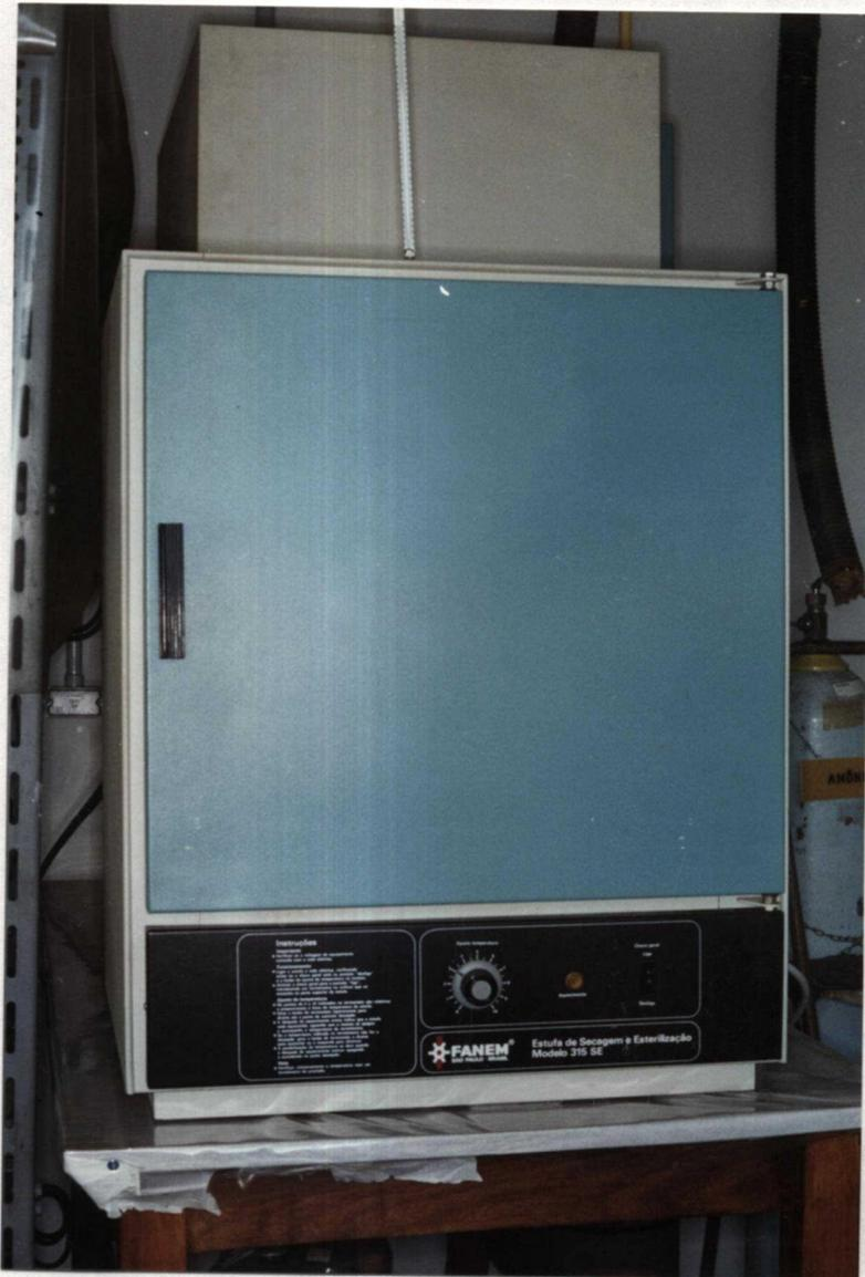
**Figura 9 - Estufa com circulação forçada de ar utilizada na secagem das microesferas.**
