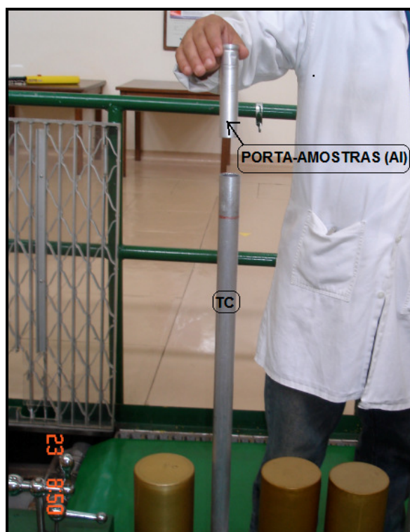
Figura 3.5 – Inserção do porta-amostras no TC.
