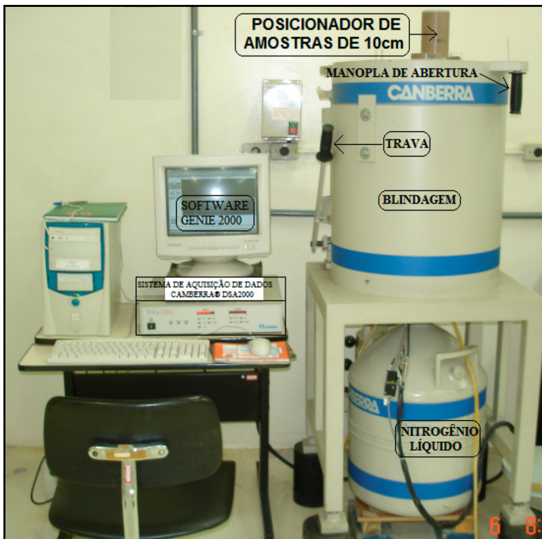
Figura 3.8 – Foto do sistema “D4” para análise por espectrometria gama do CDTN/CNEN.
