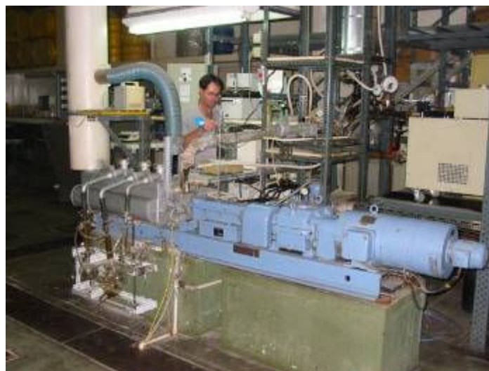
Figura 4.5 Extrusor-evaporador piloto do CDTN
