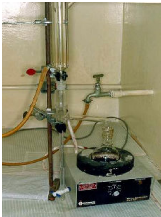
Figura 4.26 Montagem para determinação do teor de água
