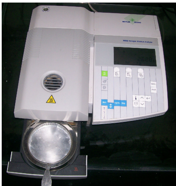
Figura 4.21 Analisador de umidade de halogênio
