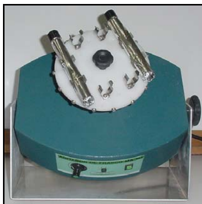
Figura 12 - Roto-torque com a suspensão da sílica SilprPi em clorofórmio.
