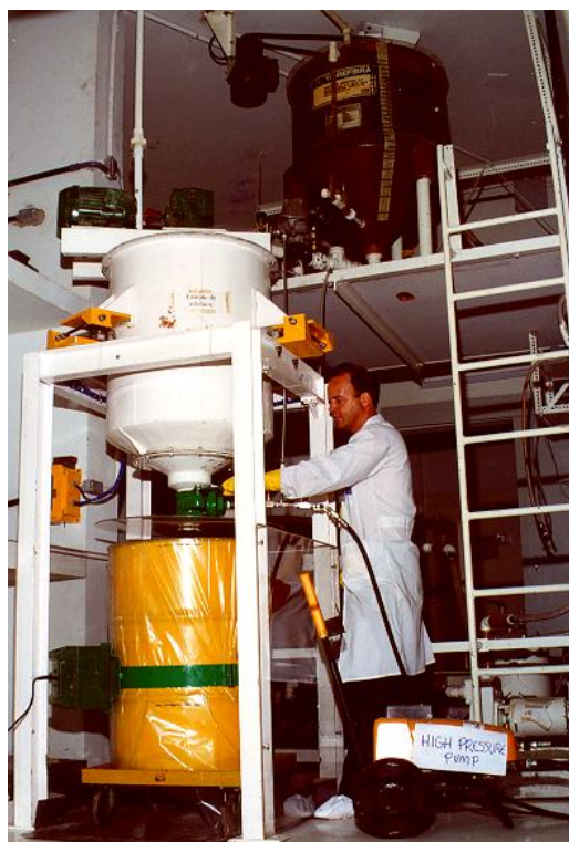
Figura 3.43 - Sistema de cimentação do CDTN.
