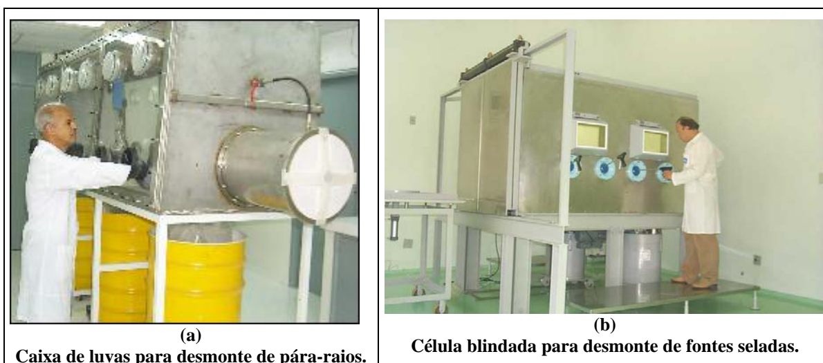
Figura 3.48 - Instalações para desmonte de pára-raios e fontes seladas no CDTN.
