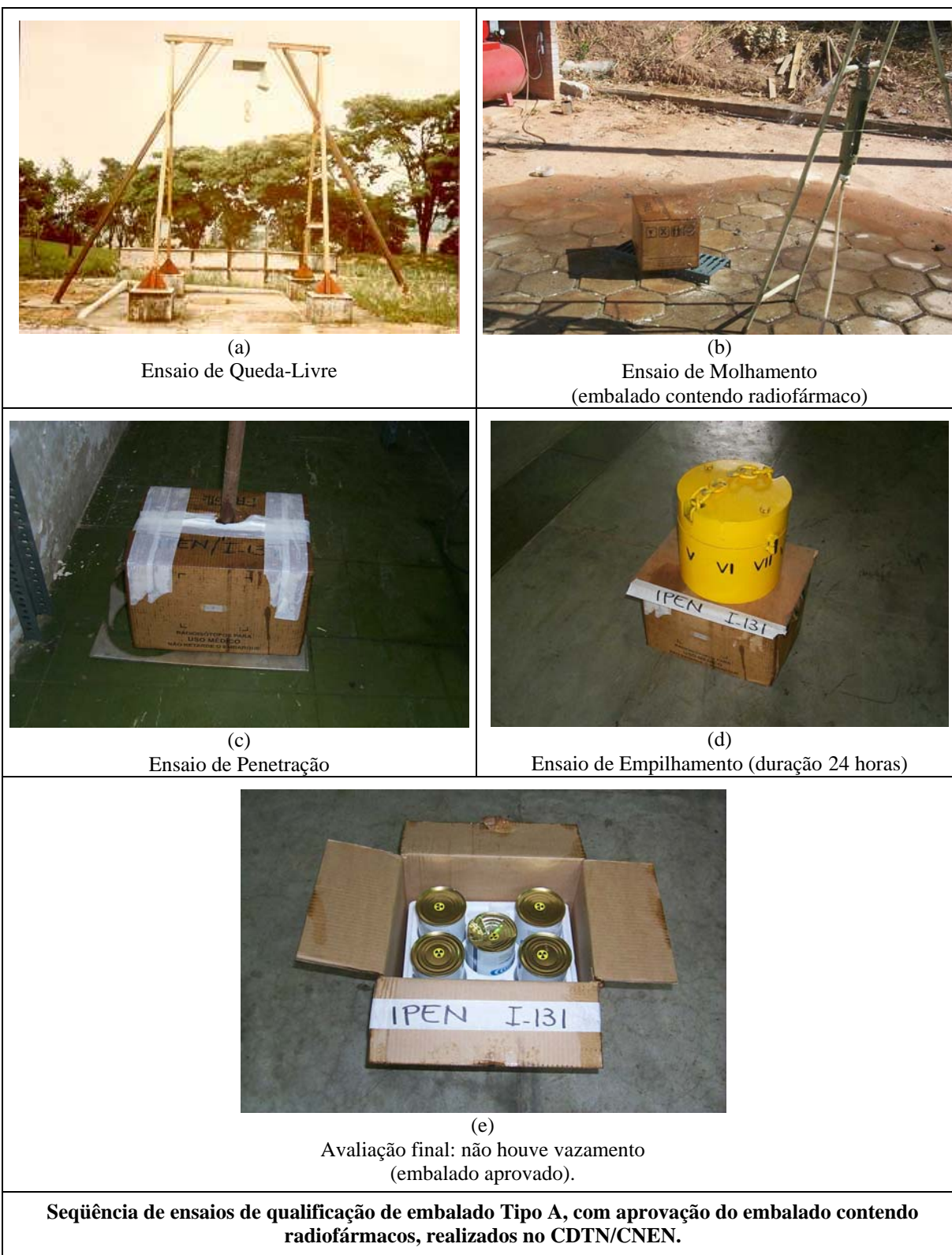
Figura 3.53 - Ensaios de qualificação de embalado Tipo A.
