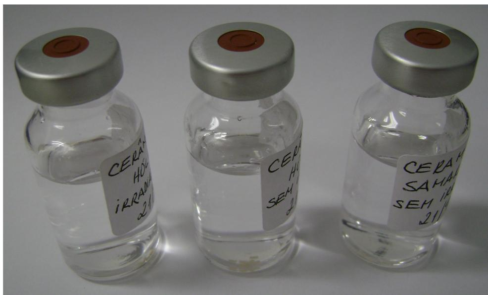
Figura 30 – Frascos ampola contendo SBF e sementes com hólmio e samário imersas para teste de solubilidade
