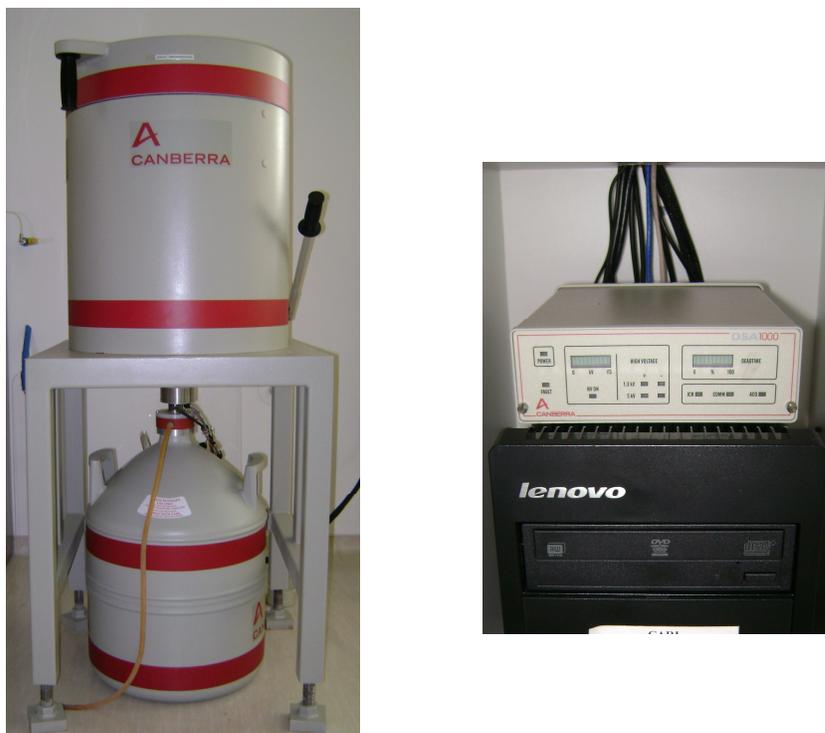
Figura 11 – Detector de germânio hiperpuro, marca Camberra, com analisador multicanal, marca Camberra DSA 1000.
