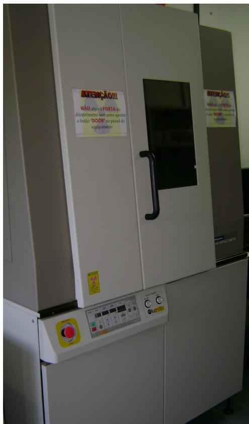
Figura 9 – Difratorômetro de raios-X, marca Rigaku, modelo Última+
