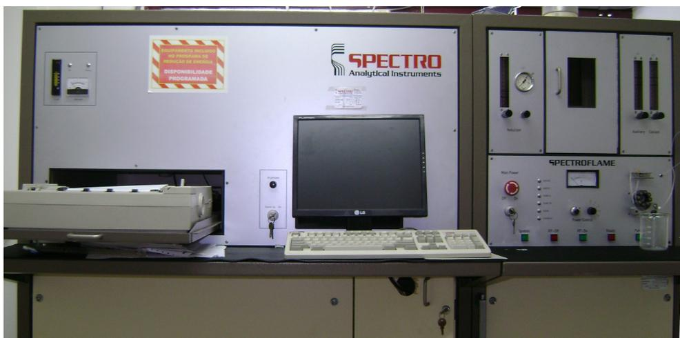
Figura 12 – Espectrômetro de emissão atômica (ICP-AES), marca Spectro, modelo Spectroflame
