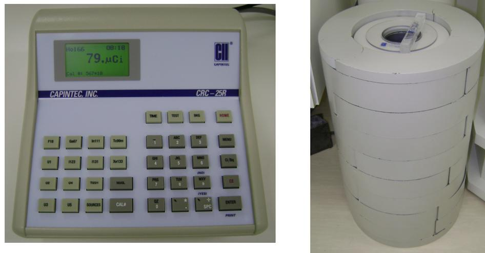
Figura 16 – Ativímetro, marca CAPINTEC, modelo CRC-25R
