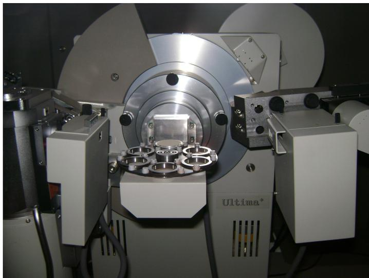
Figura 10 – Detalhe do porta-amostras do difratômetro de raios-X, marca Rigaku, modelo Última+
