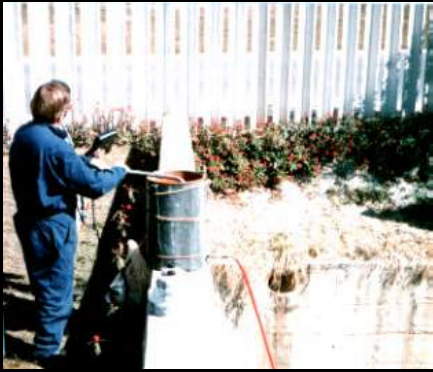
(7.3a) - PI-2. Misturamento do ^{99m}\text{Tc} já reduzido ao sedimento.
