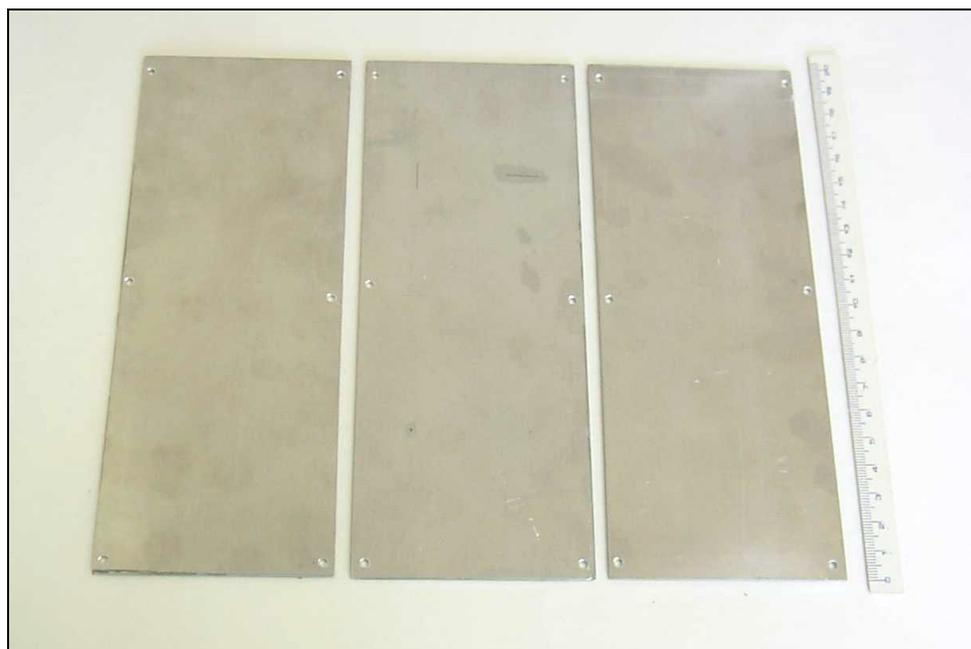
Figura 49. Partes constituintes do corpo-de-prova antes da colagem.
