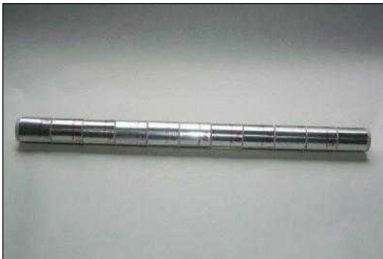
Figura 29. Conjunto de padrões do tipo cilíndrico.
