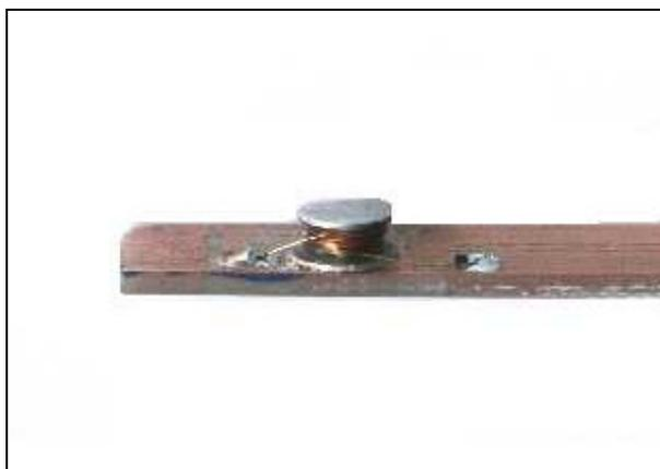
Figura 42. Detalhes do sensor de compensação.
