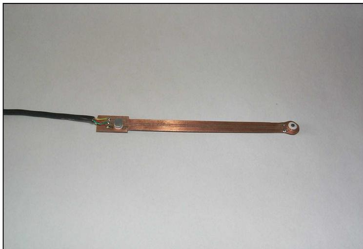
Figura 40. Detalhes internos do protótipo da sonda (placa).
