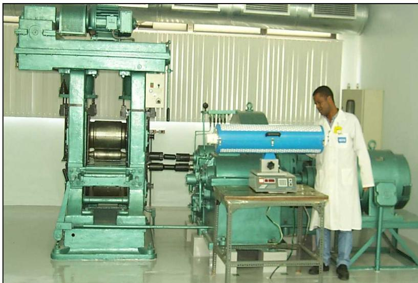
Figura 25. Laminador SUNDWIG instalado no CDTN.
