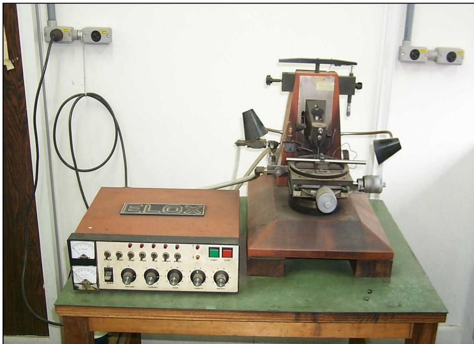
Figura 24. Equipamento de usinagem por eletro-erosão.
