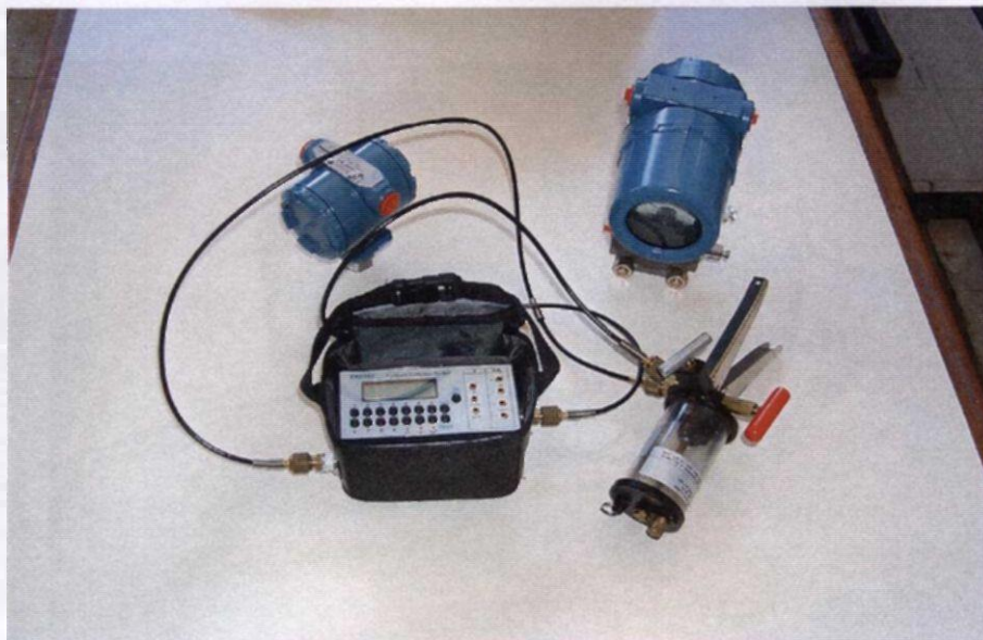
Transmissores e Calibrador de Pressão
