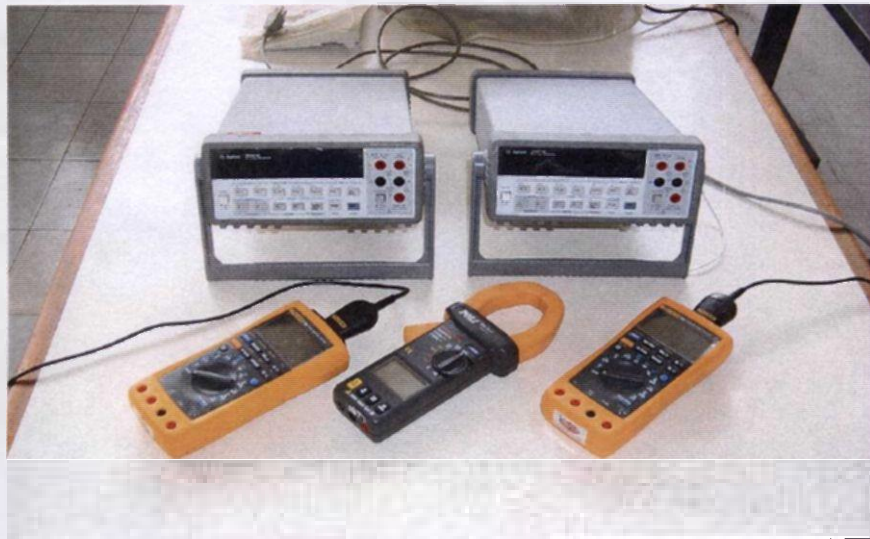
Multímetros para Medição da Potência Elétrica Fornecida ao Simulador
