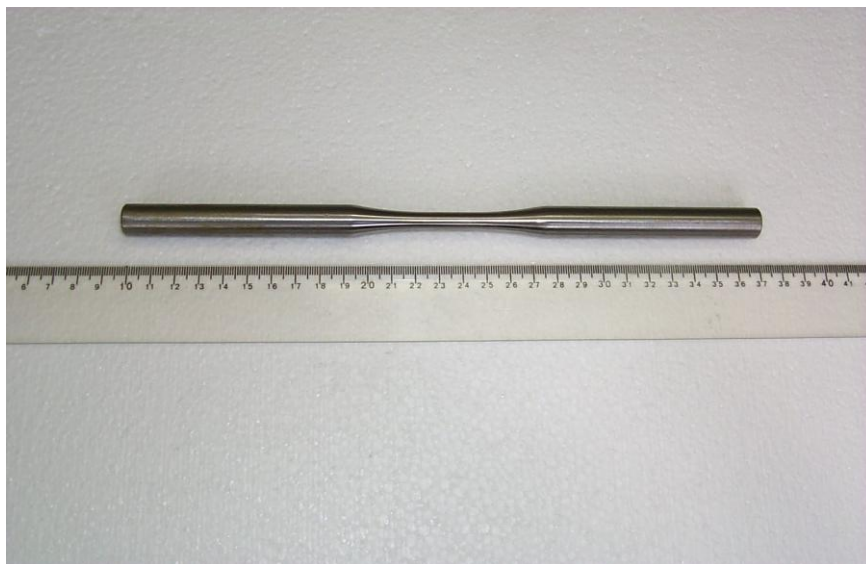
FIGURA 3.2 - Foto do corpo-de-prova utilizado nos testes de fadiga flexo-rotativa.
