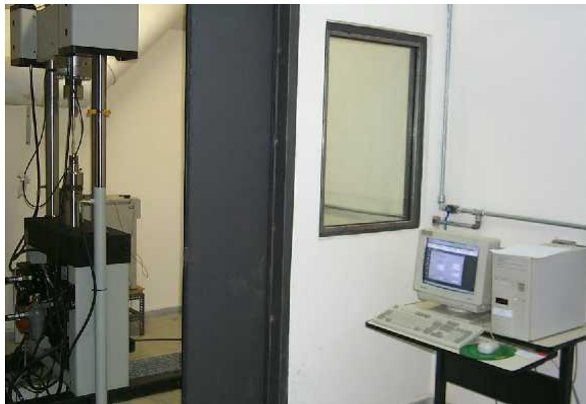
FIGURA 3.11 - Máquina de fadiga Instron 8202 com capacidade de 200 kN.
