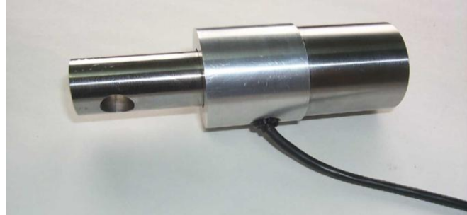
FIGURA 3.14 - Célula de carga utilizada para medição da variação do módulo de elasticidade do material submetido à fadiga.
