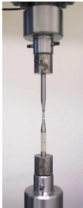
FIGURA 3.4 – Foto do corpo-de-prova para ensaios de fadiga axial instalado na máquina de fadiga axial.
