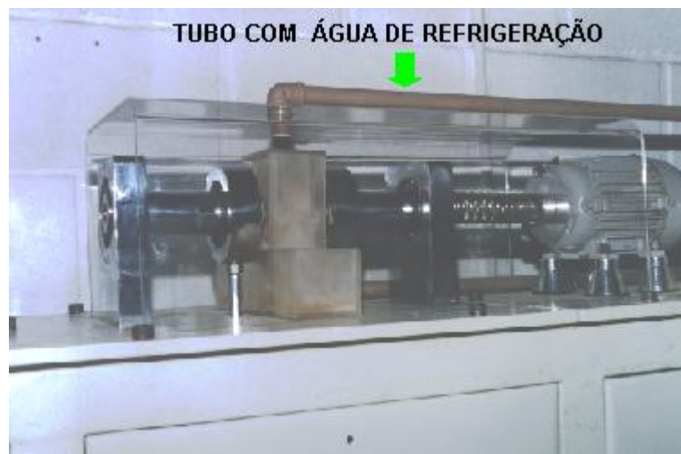
FIGURA 3.10 – Máquina de fadiga com sistema de refrigeração.
