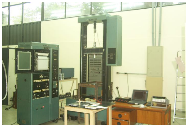
FIGURA 3.13 - Máquina universal de ensaios Instron modelo TDML.
