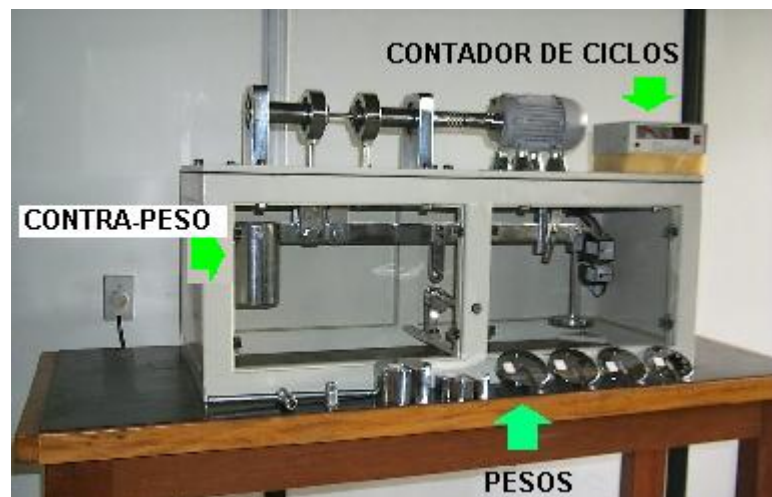
FIGURA 3.5 - Máquina de fadiga flexo-rotativa aberta.
