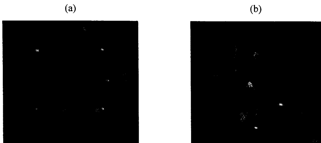
Figura 4.2 – Padrões LEED do substrato \text{Cu}_{84}\text{Al}_{16}(100) após o procedimento de preparação, obtidos nas energias de 73 eV (a) e 120 eV (b). Esses padrões não apresentam sinal de reconstrução da superfície fcc(100) do substrato.
