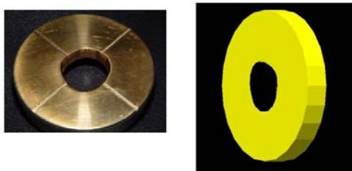
FIGURA 24. Colimador real e simulado - CATANA. Fonte: CIRRONE et al (2004b)
