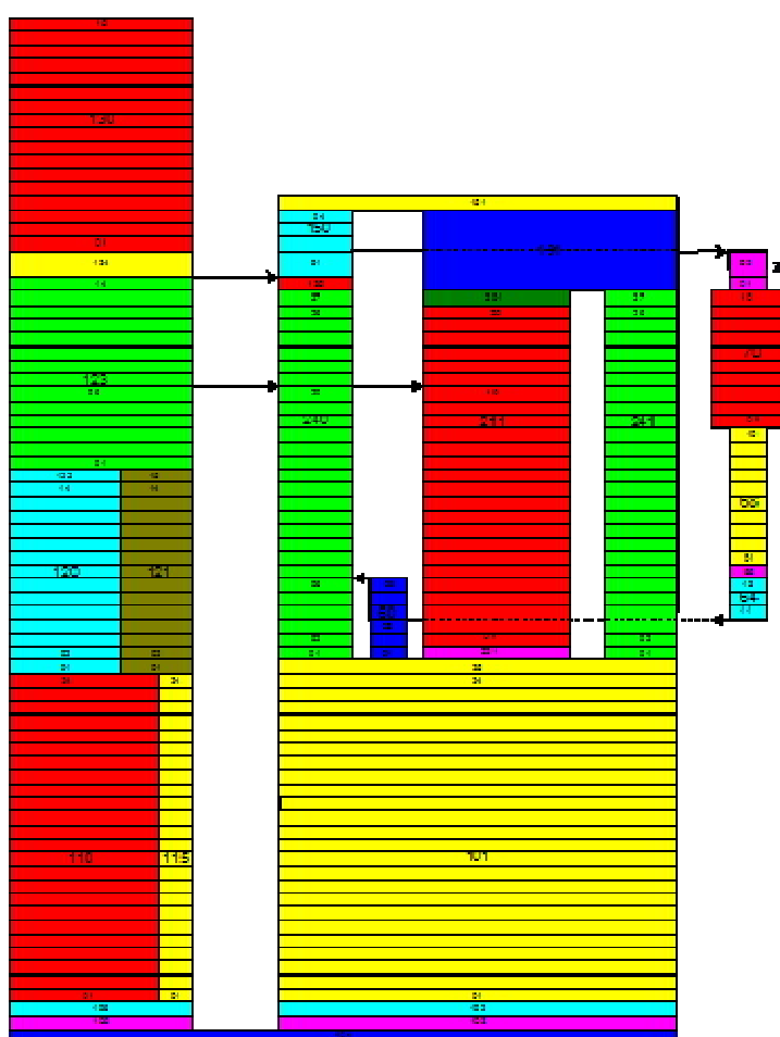
FIGURA 10 Nodalização com volumes paralelos de mesma altura no Vaso do IRIS
