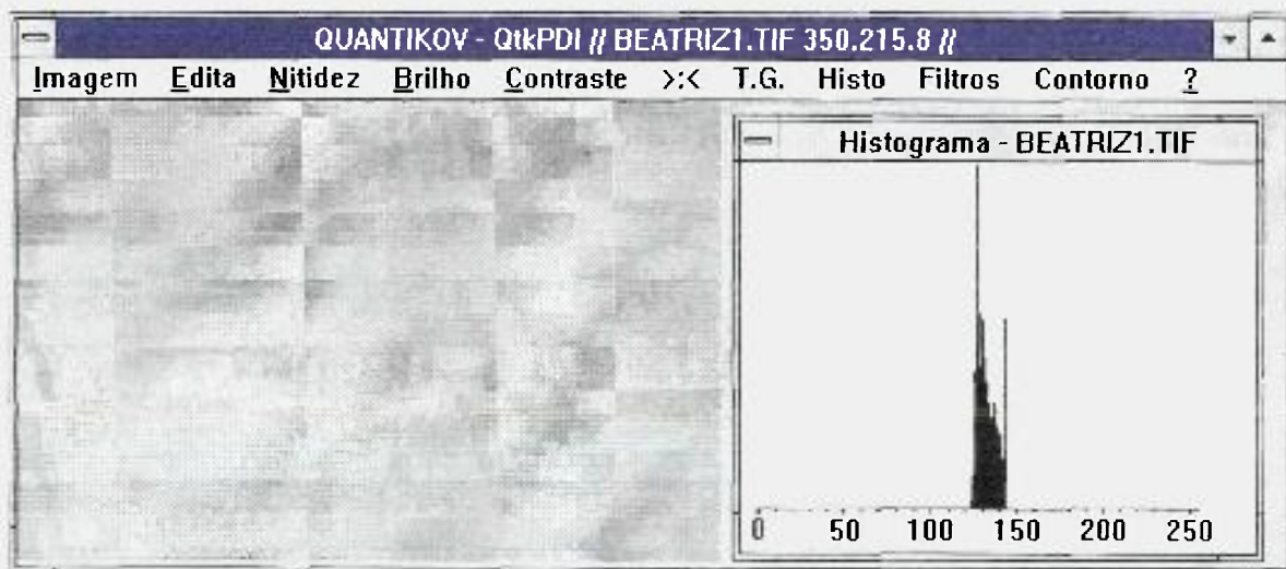
Figura 3.11a - Tela do módulo QtkIMPORT com uma imagem de baixo contraste, apresentando um histograma com um pico concentrado numa pequena faixa da escala de cinza, entre 120 e 140.
