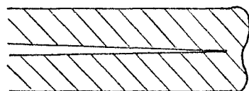
FIGURA 13 - Desenho esquemático da zona plástica na trinca por fadiga
