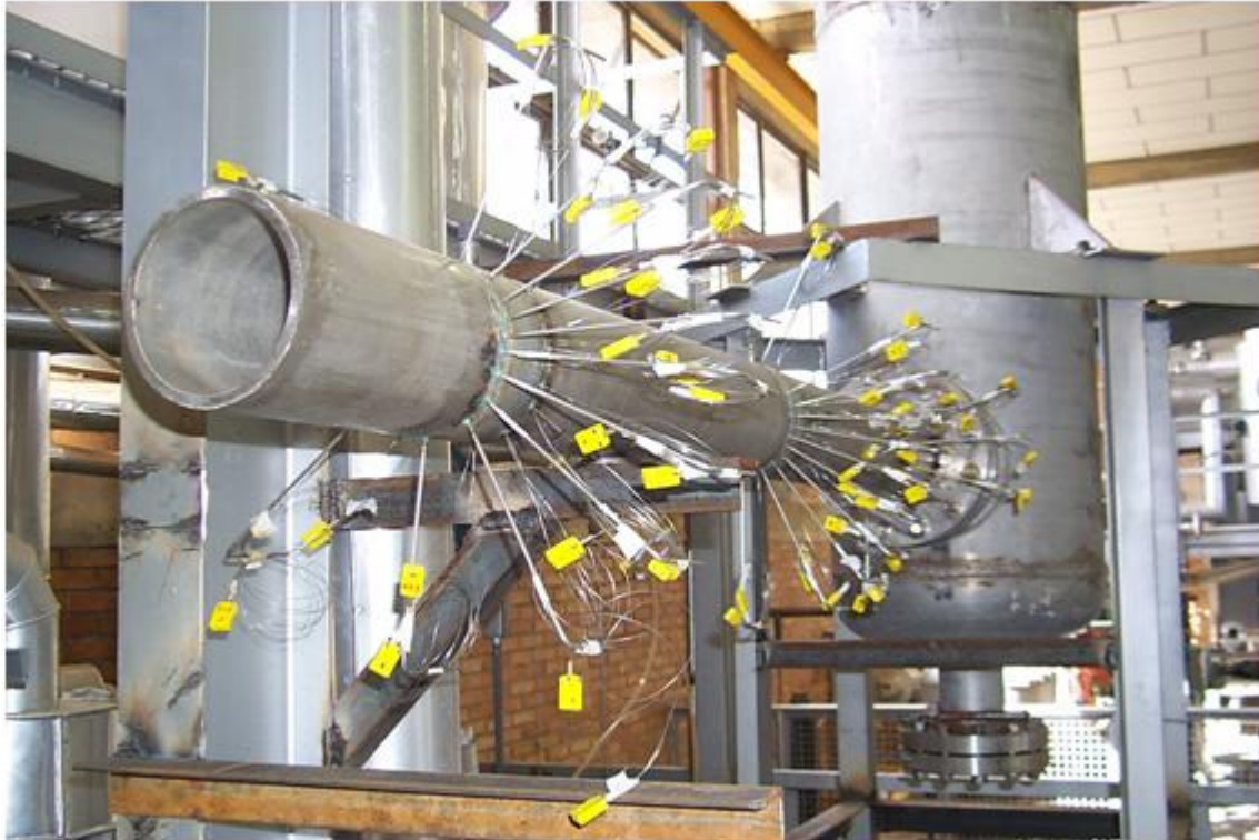
Figura 3.12 – Fotografia do tubo da seção de testes após a brasagem dos termopares.
