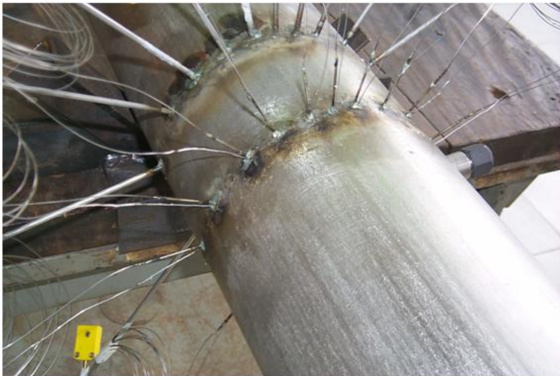
Figura 3.13 – Detalhe da Estação de Medição 1 após a brasagem dos termopares.
