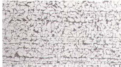
Figura 5. Metalografia revelando a microestrutura de uma amostra retirada da seção longitudinal da chapa de aço ASTM A 515 Grau 55 com um aumento de 200 x.
